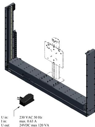
U out: Duty cycle: 5 %, max 1 min./19 min.
